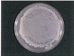
■ 洗浄前(腐敗した湿し水)
